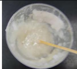
3. 一平匙量的試體 1~4，分別加入 1 平匙量的蚵殼粒、粉、細粉各為  $0.2\text{g}$  重，於漱口杯進行攪拌 1 分鐘。
