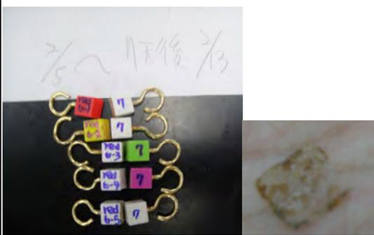
圖 6-5-2 硬掉的試體自動與積木剝離
