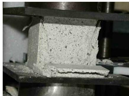
圖 4-3.1 石灰砂漿(A12)受壓破壞
