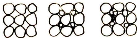
圖 2-3.6 細骨材的級配優良與否決定灰漿的強度(雲南工業大學 1995: 67)
