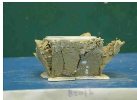
圖 4-3.3 麻絨試體受壓破壞
