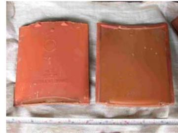
圖 2-3.2 背面帶爪溝的琉璃瓦
