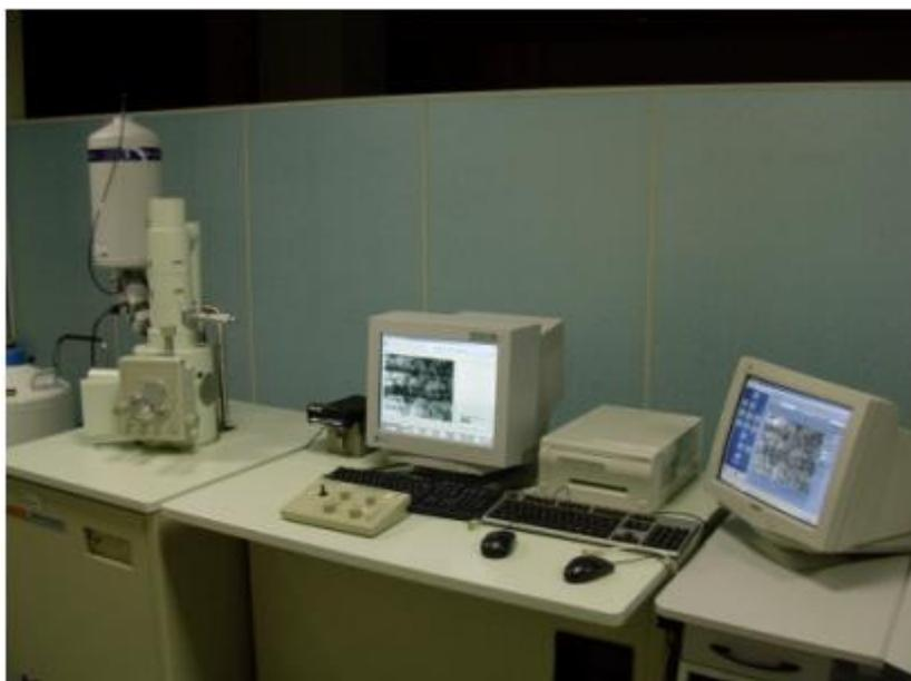
圖 3-9 掃描式電子顯微鏡〔附設能量分散光譜儀〕
